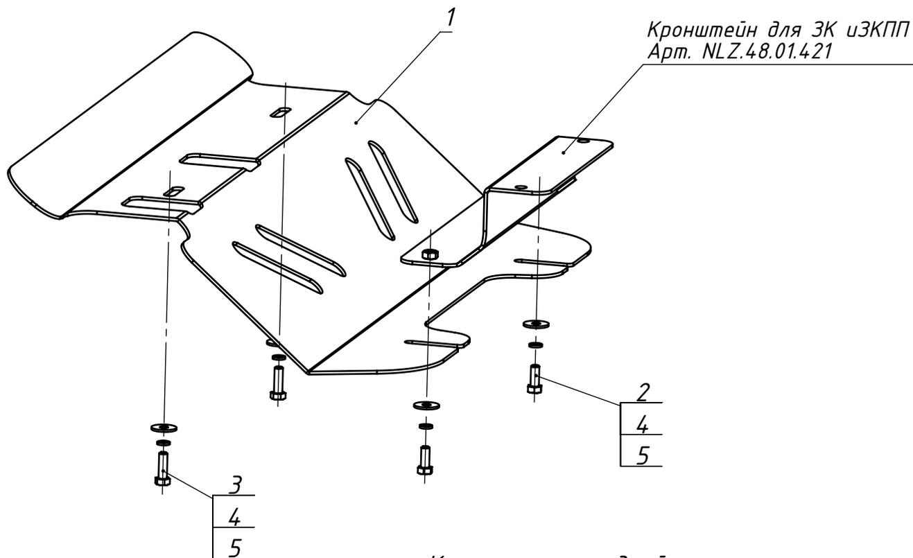
Крепление передней части защиты картера осуществляется к раме кузова, задней части к кронштейну, который также крепится к раме кузова.
